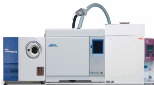
図5 におい分析に使用した GC/MS (日本電子製 JMS-Q1050GC)
